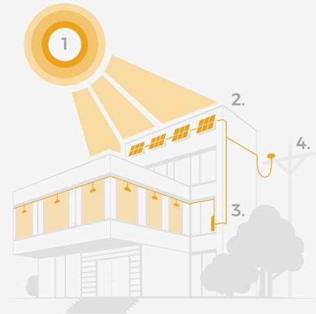
1. Solarenergie   2. Solarpanel   3. Powerbank   4. Stromnetz
